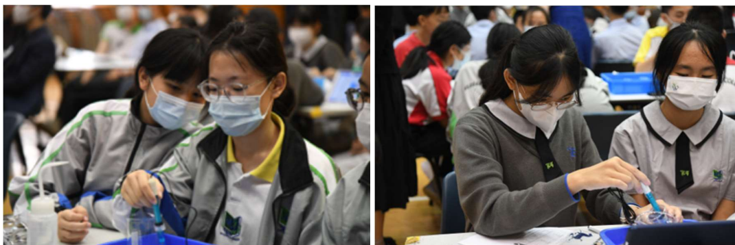
學生利用 pH 傳感器模組測試盛有 pH 4, 7, 10 及未知溶液的讀數
