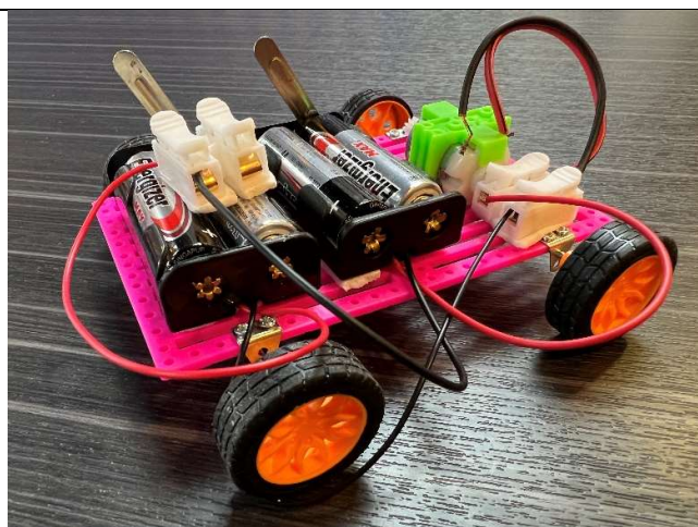
學生以串聯方式連接兩組電池到電動小車的馬達
