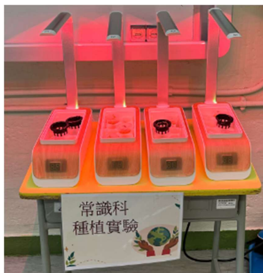
紅光及使用營養液的實驗設置
